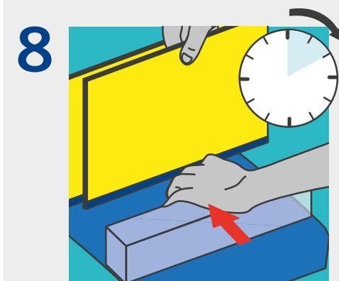
**Wichtig:** Der Klebestreifen muss immer mit der Klebefläche nach oben eingeführt werden.
